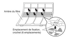
11. Remplacez les filtres à air et fermez la grille d'admission. Consultez les étapes 4 ~ 5 de « Nettoyage du filtre à air ».
